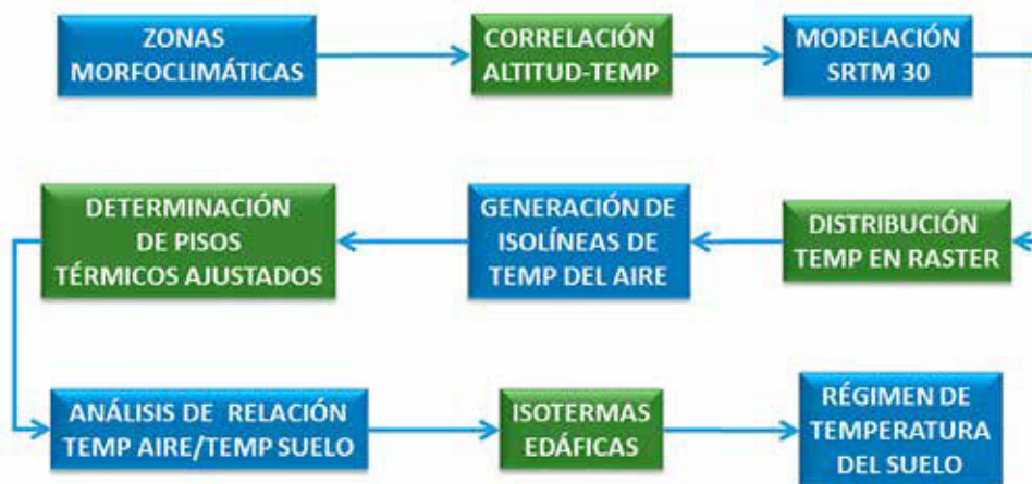
Figura 2. Procedimiento general aplicado para conocer el régimen de temperatura del suelo a partir de la delimitación de las zonas morfoclimáticas de Colombia
