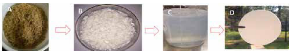
Figura 1. Esquematación de la experimentación: A) fibras de bagazo de agave; B) celulosa de bagazo de agave; C) nanocelulosa de bagazo de agave, y D) membranas de nanocelulosa de bagazo de agave
