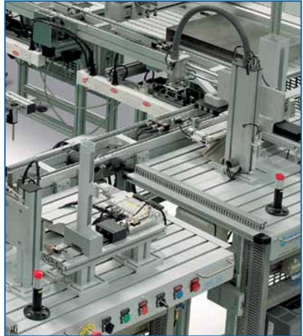
El sistema incluye toda una serie de operaciones de alimentación, manipulación, verificación, carga, etc. realizados mediante componentes de diferentes tecnologías (neumática, hidráulica, sensórica, robótica, etc.).
