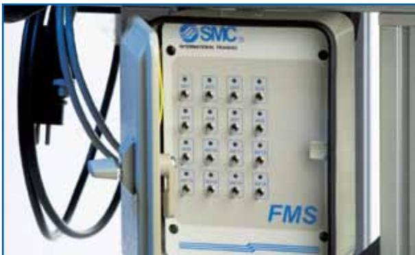
FMS-200 incluye el sistema de simulación de averías que permite generar hasta 16 disfunciones que el usuario tendrá que diagnosticar.
