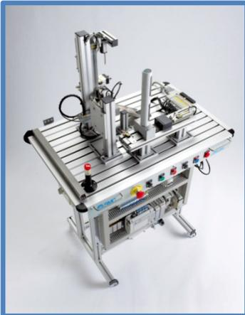
La estación FMS-202 es la encargada de insertar un rodamiento en el alojamiento de la base. El rodamiento podrá ser de diferentes alturas.
