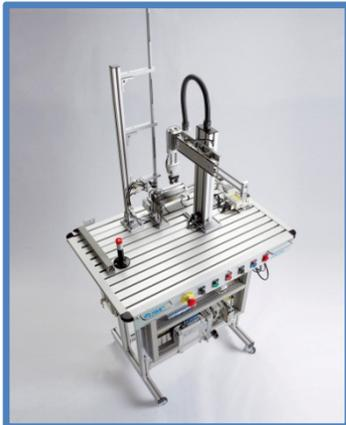
La estación FMS-206 inserta cuatro tornillos en la base del producto en proceso (mecanismo de giro).
