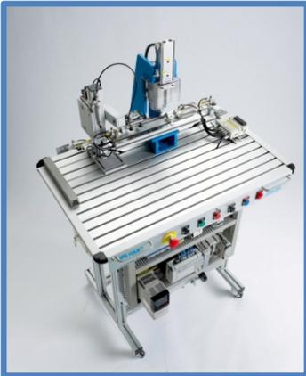
La estación FMS-203 realiza el prensado hidráulico del rodamiento insertado en la estación anterior.
