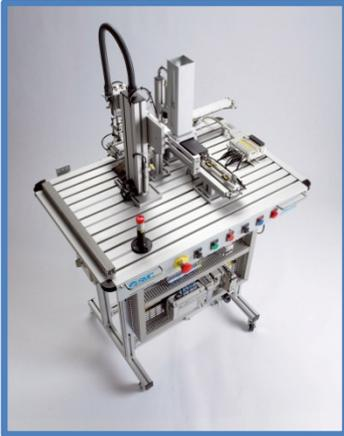
La estación FMS-201 realiza el proceso de alimentación de la base, que sirve como soporte al producto ensamblado.
