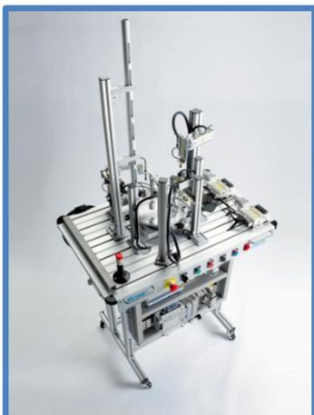
La estación FMS-204 monta un eje sobre el producto en proceso. Existen dos tipos de ejes, dependiendo del material: aluminio y nylon.
