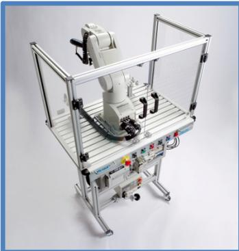
La estación FMS-207 integra la robótica como tecnología. El robot atornillará los cuatro tornillos suministrados por la estación anterior. Además podrá realizar operaciones de cambio de ensamblaje de ejes y tapas.
