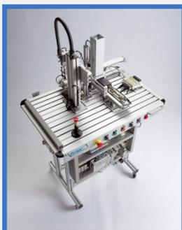
La función de esta estación es realizar la alimentación de la base que sirve como soporte del dispositivo de giro que va a ser ensamblado en el sistema FMS200, y su desplazamiento hasta el pallet situado en el sistema de transporte (transfer).
