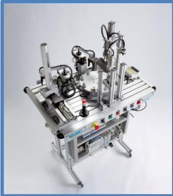
La estación FMS-205 se encarga de insertar una tapa sobre el conjunto. Existen seis tipos de tapas, dependiendo del material, color y altura.
