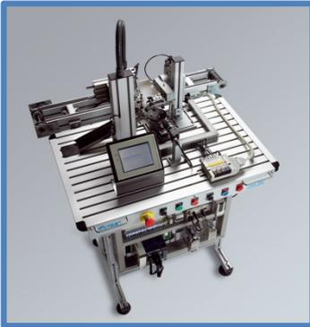
La estación FMS-210 integra la tecnología de visión artificial. En esta estación el producto en proceso (mecanismo de giro) es trasladado a la posición de inspección, en la que una cámara de visión artificial examina las variables definidas en el control de calidad.
