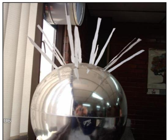
Figura 3.2 El domo esférico del generador de Van de Graaff y las tiras de servilleta se cargan eléctricamente
