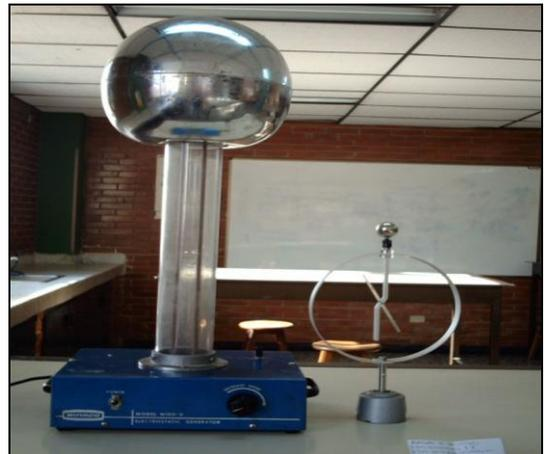
Figura 2.1 Se acerca el Electroscopio a un Generador de Van de Graaff para cargarlo eléctricamente.
