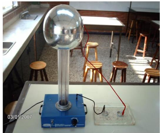
Figura 3.4 Generador de Van de Graaff conectado a dos electrodos por medio de conectores
